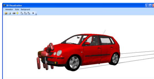
Figuur 5.3: Computeranimatie PC-Crash van een VW Polo met een wild zwijn met 60 km/h
