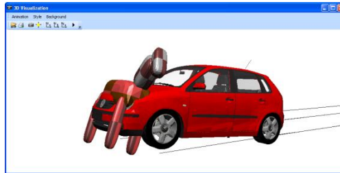
Figuur 5.4: Computeranimatie PC-Crash van aanrijding van een VW Polo met een edelhert met 100 km/h
