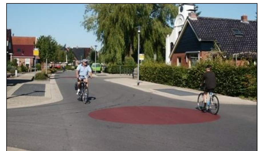
Gelijkwaardige kruispuntoplossing met attentievak, verharding: asfalt
