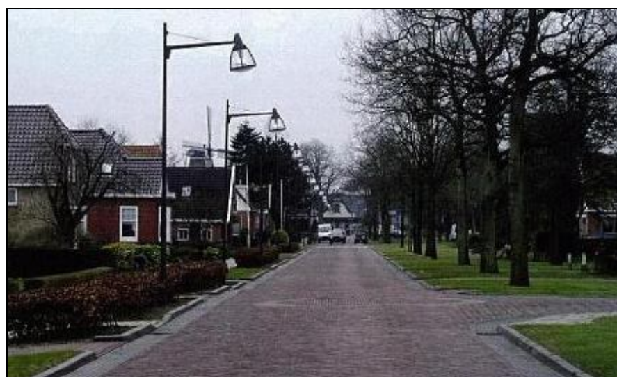
Figuur 54, Gelijkwaardige kruispuntoplossing met attentievlak, molgoten en het gebruik van stoepranden, verharding klinkers
