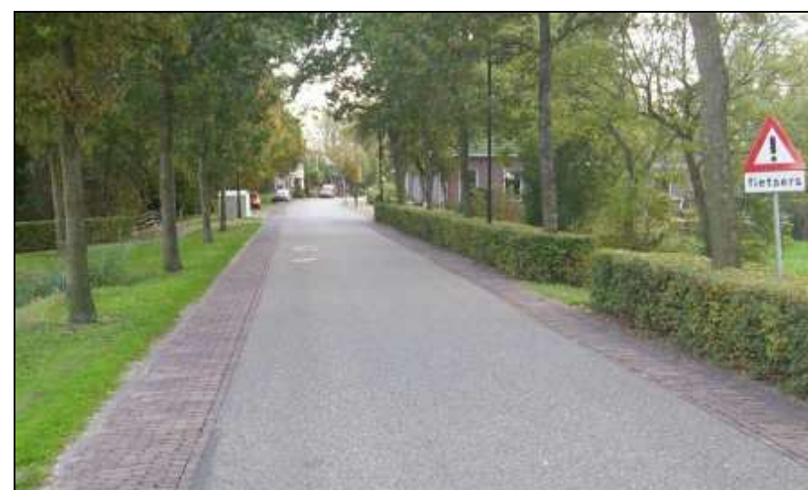
Figuur 64, Wegvak waarbij sprake is van mening van verkeer, aan weerszijden een rabatstrook, verharding asfalt in combinatie met klinkers
