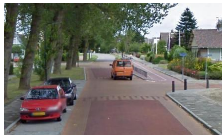
Figuur 57, Gelijkwaardige kruispuntoplossing behalve voor de fietsers, verharding klinkers
