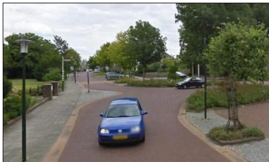
Figuur 44, Gelijkwaardige kruispuntoplossing met asverspringing, verharding klinkers
