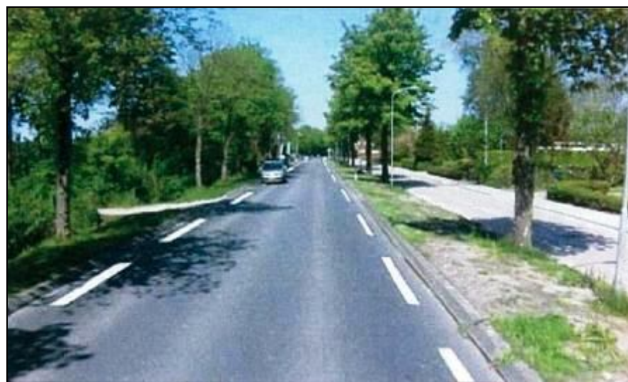
Figuur 29, Erftoegangsweg type 1 met kantbelijning, verharding asfalt
