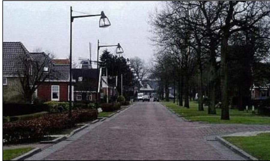
Gelijkwaardige kruispuntoplossing met attentievak, molgoten en het gebruik van stoepranden, verharding: klinkers
