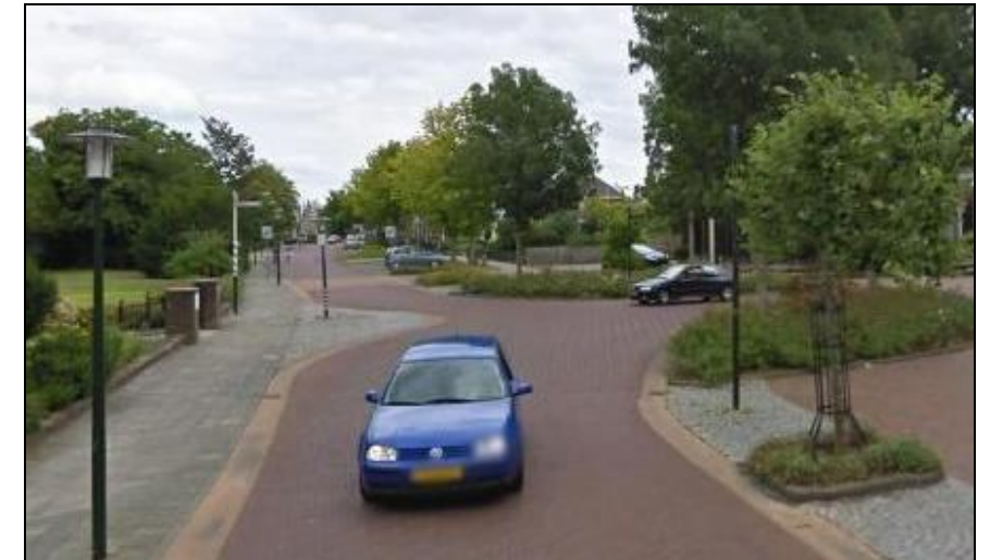
Gelijkwaardige kruispuntoplossing met asverspringing, verharding: klinkers
