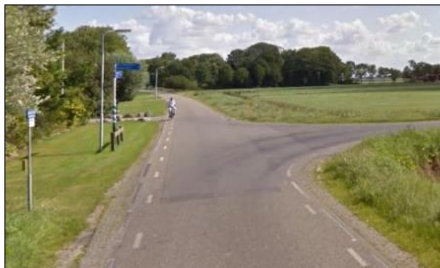
Figuur 56, Sobere kruispuntoplossing voldoet aan CROW-richtlijnen, verharding asfalt
