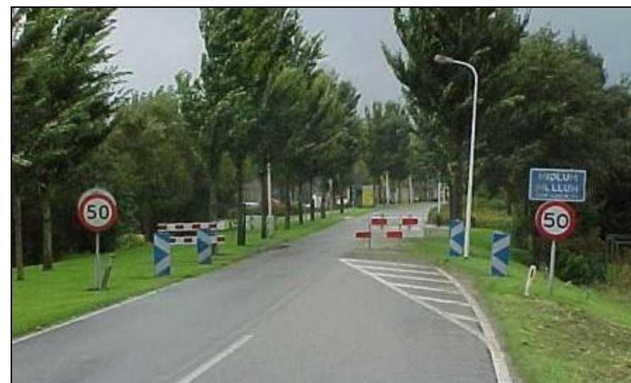
Figuur 72, poortconstructie met wegversmalling waarbij de rechter weghelft wordt opgeheven en na de poortconstructie weer verder gaat.
