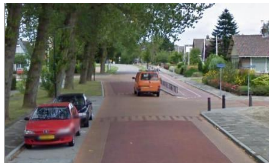
Figuur 84, Gelijkwaardige kruispuntoplossing behalve voor de fietsers, verharding klinkers
