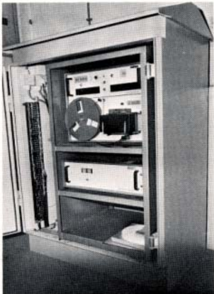
3. Standaard telpuntkast (onder) met DFA 73 en DES 398 apparatuur, veelal in een telkeet geplaatst (boven).
