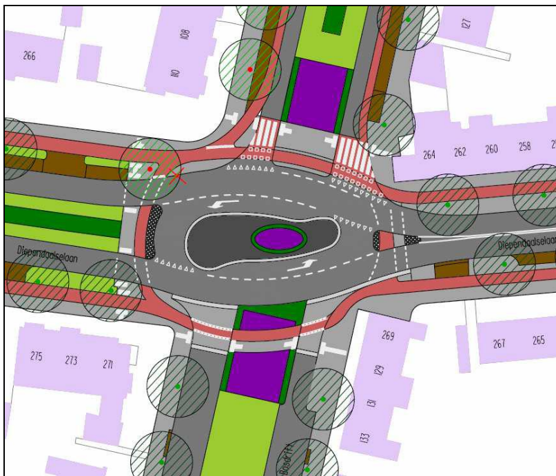
Voorbeeld van een voorrangspointje met linksafvakken in Hilversum
