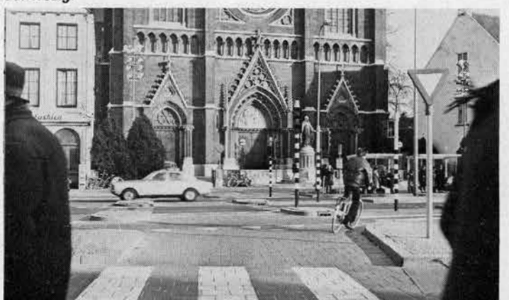
11. Kruispunt Heuvelring/Pieter Vreedeplein; verkeerslicht kan voor het fietspad worden geplaatst, ruimte voor vrije rechtsafstrook is aanwezig.
