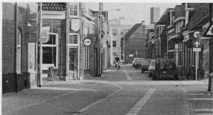
14 (geheel boven). Kruispunt Boomstraat/Prunusstraat: geen onderscheid fietsroute-hoofdrijbaan in de voorrangsborden. Haaietanden ontbreken.
