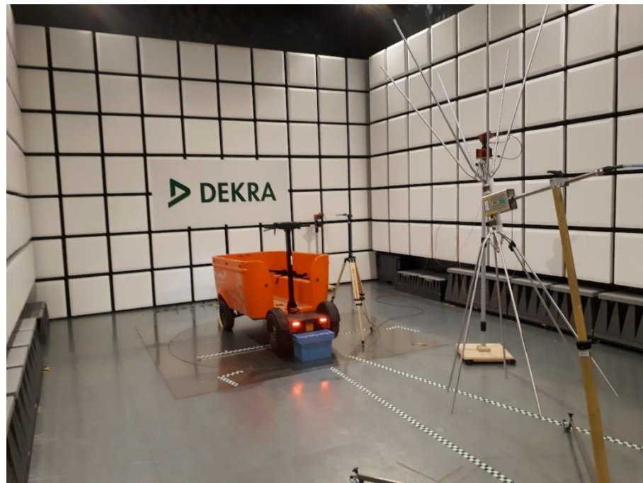
Figuur 15: H304 op de EMC opstelling van DEKRA te Arnhem
