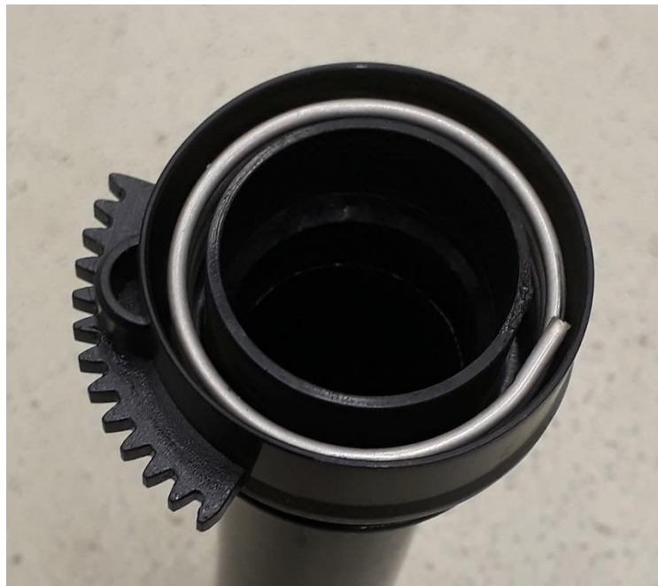
Figuur 17: Handvat met (gebroken) veer
