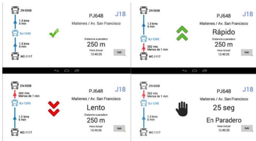
Figuur 5.5: Schermafbeeldingen van boordcomputers met regelmaatsturing: perfecte regelmaat, versnellen, vertragen en wachten op de halte (Lizana et al, 2014).
