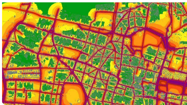
Figuur 2: voorbeeld van een (deel van een) geluidsbelastingskaart, waarin het geluid ten gevolge van het wegverkeer in kaart is gebracht
