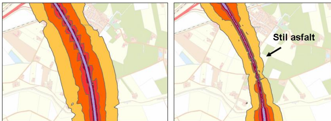
Figuur 4.2: Voorbeeld geluidscontouren rondom een provinciale weg voor en na het toepassen van stil asfalt
