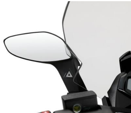
Figuur 9 BMW's Side View Assist op de BMW C 650 GT, te herkennen aan een oplichtend waarschuwingssymbool in de voet van de spiegel. Bron: (BMW Motorrad, 2019)
