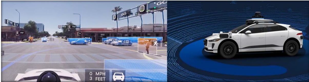
Figuur 6: LIDAR-technologie in Waymo-voertuigen (Waymo, z.d.)
