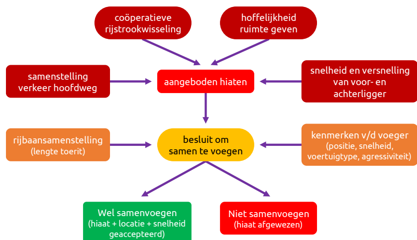
Figuur 4.3: Conceptueel raamwerk in-/uitvoeggedrag (Maarseveen, 2017)
